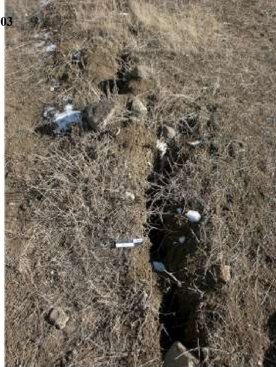
Նկ. 10,11. Տեղաշարժման և սեխման սողանքային ճաքեր:
