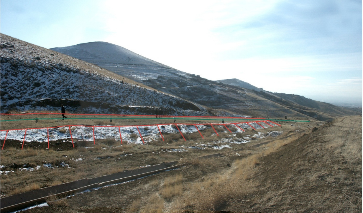
Նկ.1. Երկրաֆիզիկական երկայնական 0-0 պրոֆիլը և ՈՒԷԶ-ի կետերի դիրքը թունաքիմիկատների գերեզմանոցում
